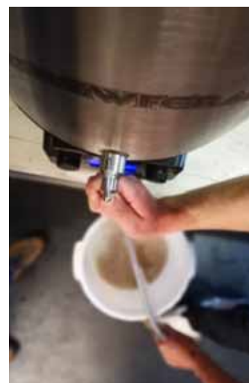
La bière est soutirée après avoir tourné énergiquement le contenu (whirlpool) de la cuve de brassage
